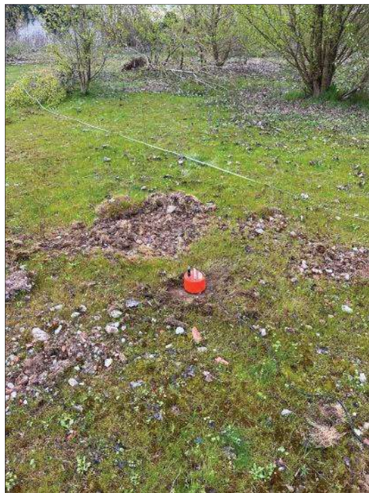
Misura del microtremore sismico mediante tecnica H.V.S.R.
