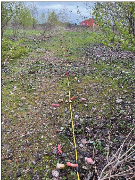
Stendimento sismico M.A.S.W.
